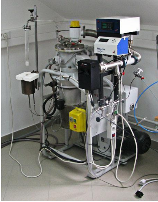
Уређај за температурно програмирану десорпцију (TPD-MS). Особа задужена за рад на уређају др Игор Милановић.
