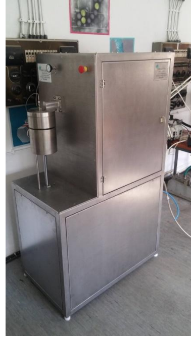
HSA-UNLS – Уређај за карактеризацију сорпције водоника, кинетичка мерења и циклирање. Особа задужена за рад на уређају др Игор Милановић.
